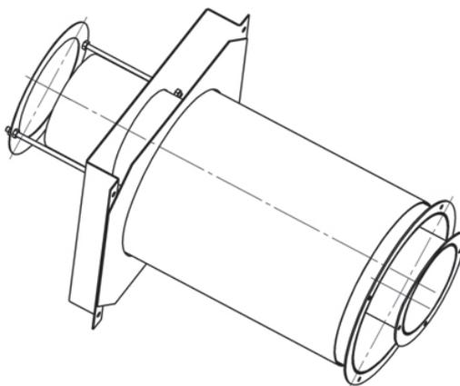
Рисунок 5 - Воздухозаборная труба с каналом дымоудаления
